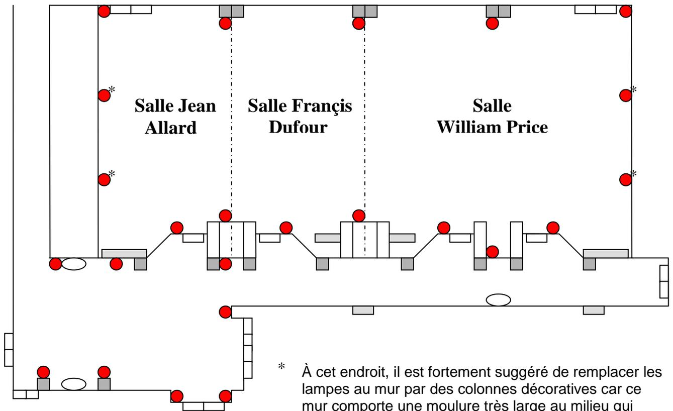
\* À cet endroit, il est fortement suggéré de remplacer les lampes au mur par des colonnes décoratives car ce mur comporte une moulure très large au milieu qui limite la projection du faisceau lumineux vers le plafond.
